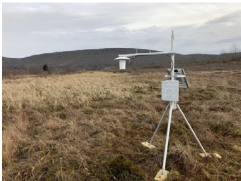
远地点吸气辐射屏蔽有助于测量西弗吉尼亚州国家野生动物保护区迦南谷研究气象站的温度
