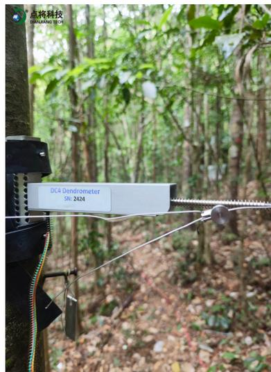
树木生长和茎流监测系统包含多个周长生长测量传感器，用于对植物周长变化进行高精度和连续测量，周长变化的信号通过覆盖在测量对象上的金属绳接收。多个茎流传感器，用于监测树木的液流状态，工作时两个探针插入树干上下不同部位，上部探针用衡流加温，两个探针之间形成温差。液流上升时，带走热量，两个探针之间温差变小。温差和液流之间具有函数关系。通过测量温差算出液流量。不同的液流量产生不同的温度差，传感器感应由此产生的微小的电压，从而提供液流计算的数据。
