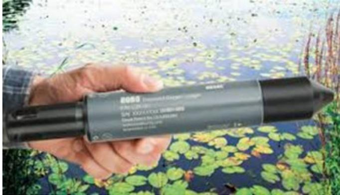
基于其在长时间内提供连续溶解氧和温度测量的能力在此期间，该团队选择了 HOBOTM 的 U26-001 溶解氧数据记录仪，这是一款价格实惠、高性能的溶解氧数据记录仪。
