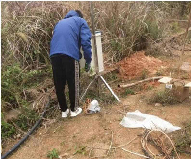
蒸渗测量系统是点将科技自行设计和制作的,用于评估水在土壤中利用程度的指标,是研究水分平衡、物质平衡、土壤溶质运移的全新工具,它的特点是能够量化测量裸地的实际蒸散量,以及覆盖有植被的土地的实际蒸散量。
